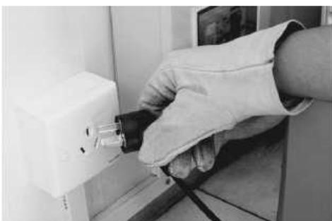
5) Подключите машину к сети. Если вилка шнура машины не достает до розетки, используйте исправный удлиннитель в хорошем состоянии.
