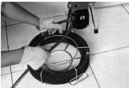
8) Как только засор устранен, поверните переключатель в положение OFF. Вытяните гибкий вал из трубы. После использования тщательно промойте и слейте воду из гибкого вала, муфты и насадки, чтобы избежать повреждающего действия некоторых составов для очистки сливов. Вытрите их насухо. Сохраните для дальнейшего использования.
