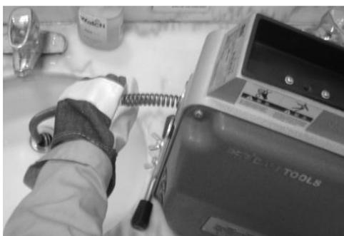
7) Пропустите достаточно длины гибкого вала через машину, чтобы образовалась почти полуокружность между машиной и отверстием слива. С зажатой рукой в перчатке на гибком шланге надавите на рукоятку другой рукой, чтобы начать вращение гибкого вала. Надавите на верхнюю часть петли гибкого вала для
