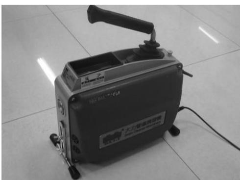
9) После использования позвольте мотору свободно работать 2-3 минуты. Впрысните смазочное масло в масляные отверстия. Можно использовать машинное масло. Уберите машину в сухое место для использования в будущем.
