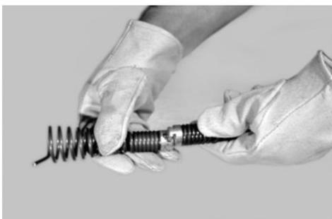
2) Выберите и установите соответствующую насадку на конец гибкого вала. Муфта с Т-образным пазом позволяет защелкнуть инструмент в муфту гибкого вала.
