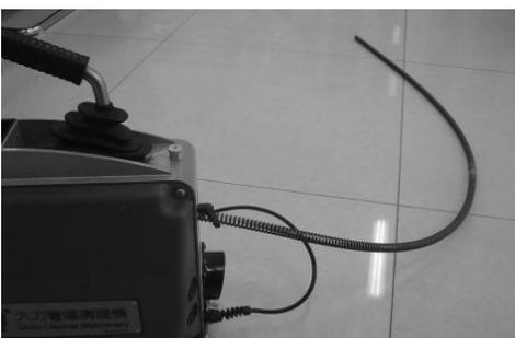
4) Выпустите гибкий вал на 2~4 м из задней части машины. Уберите остальную часть вала для дальнейшего использования.
